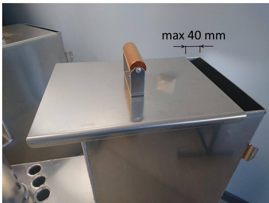
Bild 4. Det maximala tillåtna öppna läget av luckan under eldning
