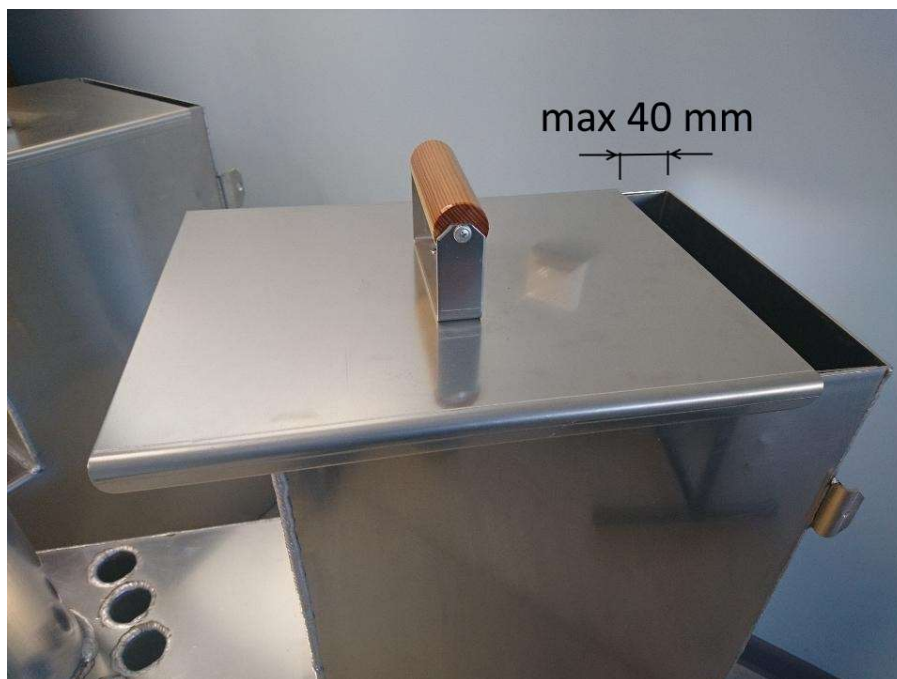
Kuva 4. Luukun sallittu aukeama lämmityksen aikana
