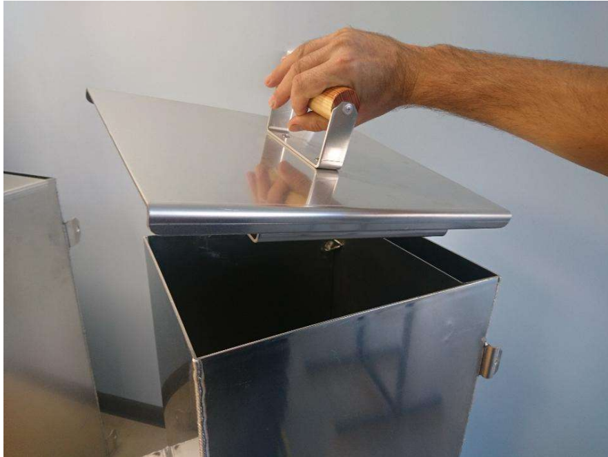
Kuva 5. Luukun kädensijan oikea käyttö
